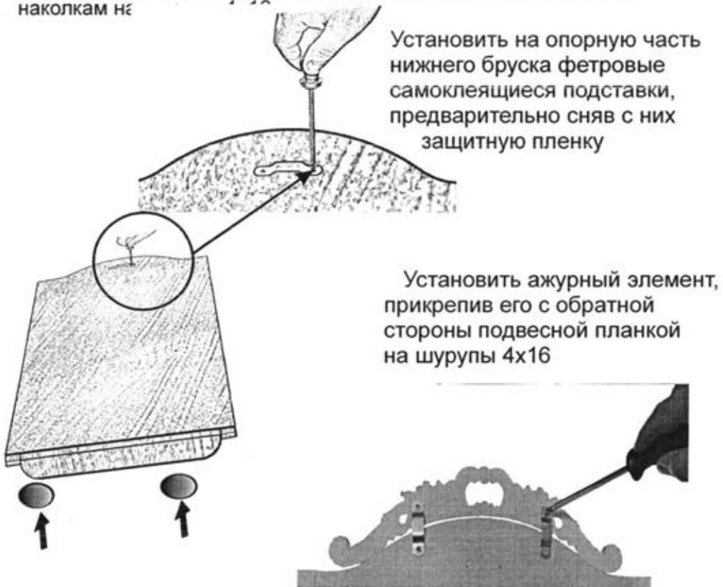
Центральное зеркало необходимо **устанавливать так**, чтобы оно стояло **на горизонтальной опоре** (столе, комоде и т.д.) и **фиксировалось к вертикальной опоре**. Для этого в стене просверлить отверстие, в которое вбить дюбель и ввернуть подвесной крючок.
