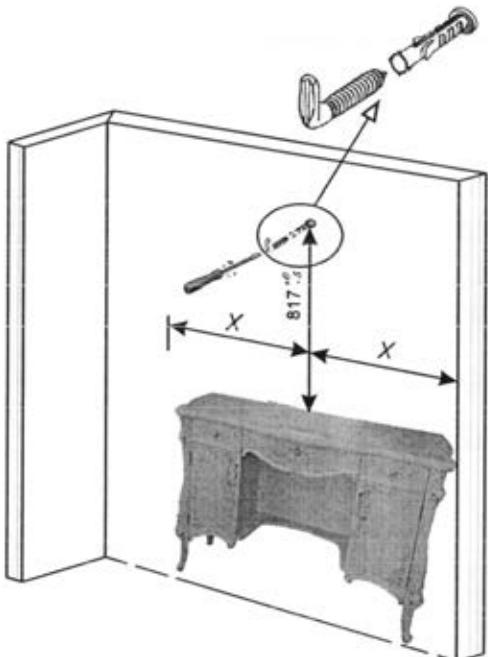
817<sup>+0</sup><sub>-5</sub> - расстояние от горизонтальной опоры до центра отверстия размер в мм.
